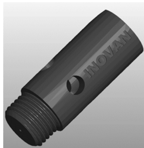
Altes CAD-Design der Venturi-Düse für die subtraktive Fertigung
